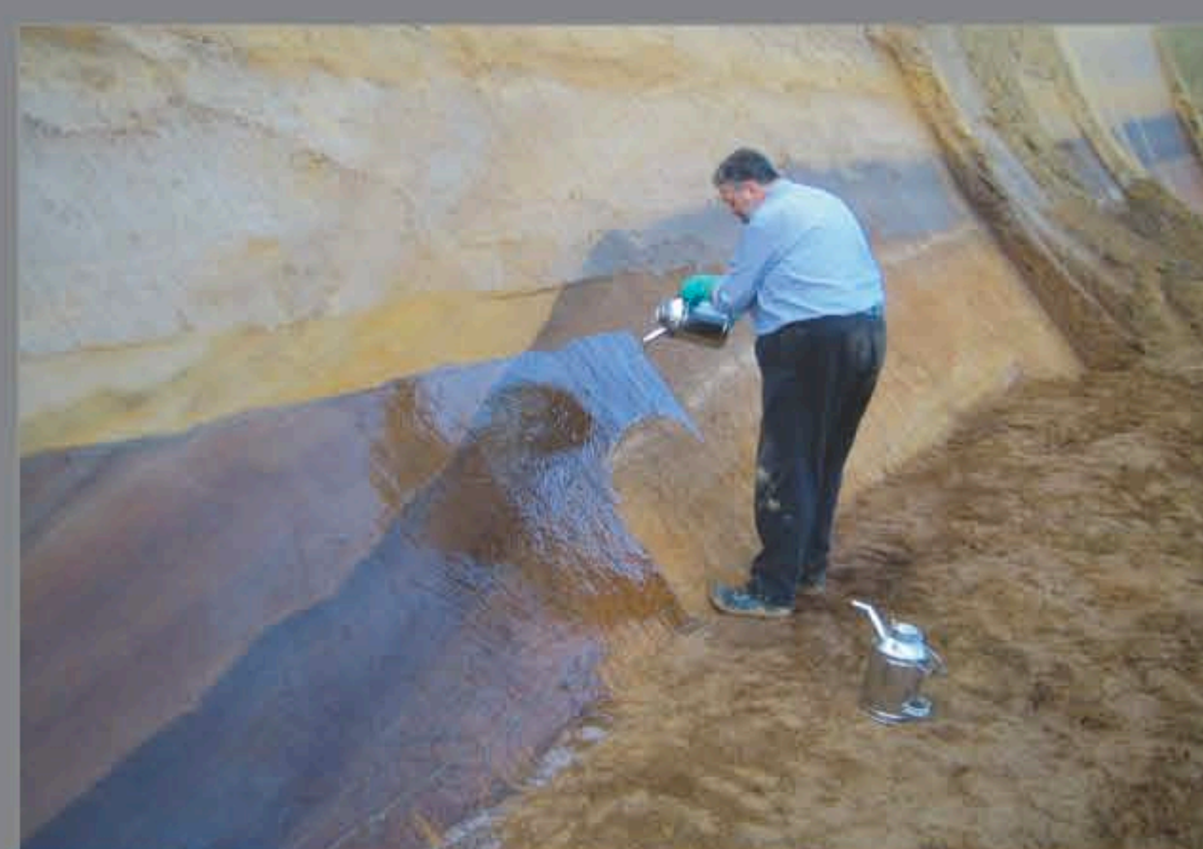
Mit Kunstharz und Lack wird die geglättete Wand übergossen. Der Speziallack dringt in die Poren ein, verklebt das Sediment ...
