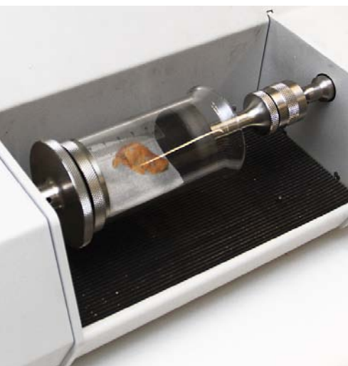
Pulverpyknometer zur Bestimmung der Rohdichte
