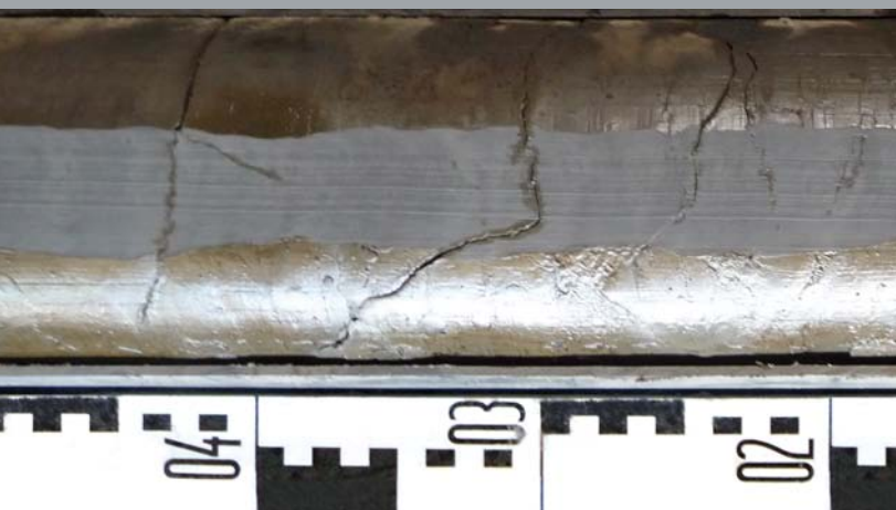
Bohrkernabschnitt mit deutlicher Ölkontamination aus einer Probebohrung
