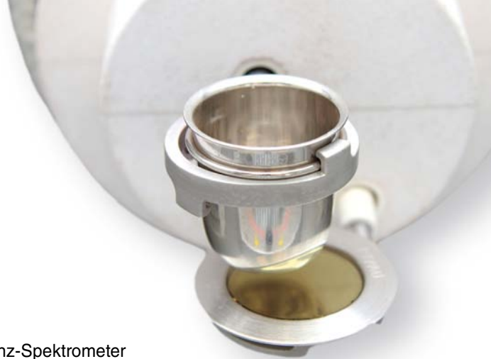
Schmelztiegel im Einsatz bei der Silikatanalyse
