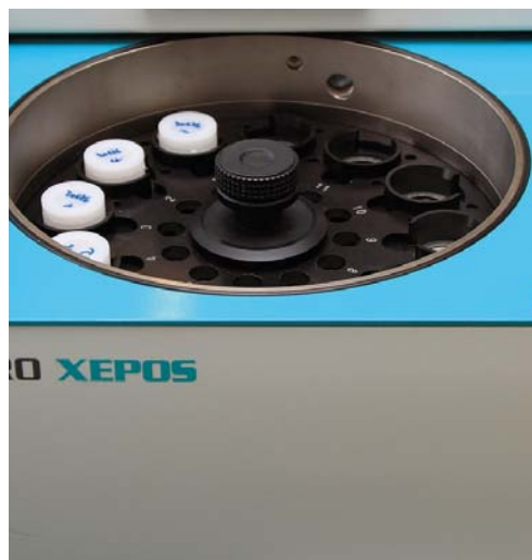
Probenwechsler des Röntgenfluoreszenz-Spektrometers
