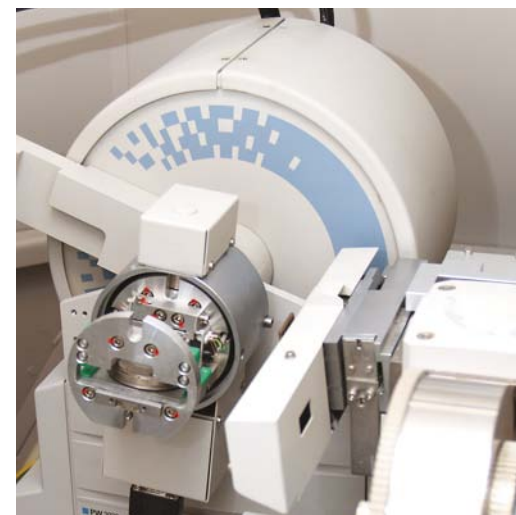
Diffraktometer zur Röntgenbeugungsanalyse
