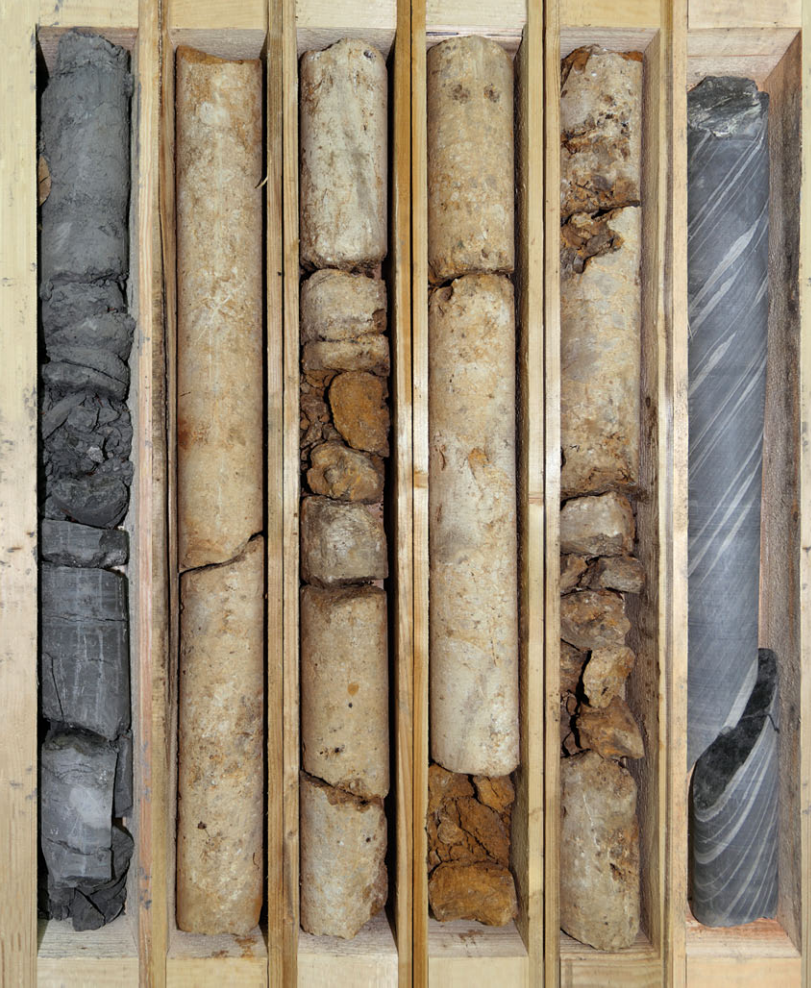
Bohrkerne, in der Mitte helle Kalksteine, die stark geklüftet sind und damit potenzielle Wegsamkeiten für Thermalwasser bieten
