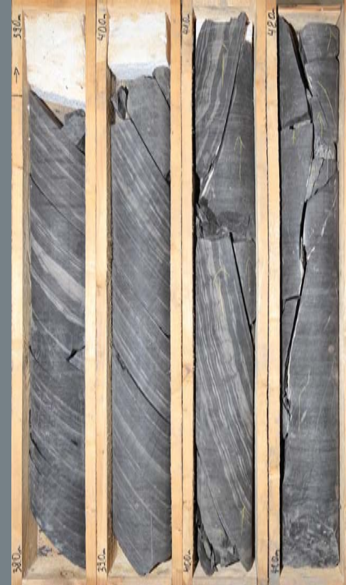
Beispiel für Bohrkerneliefernde mit schräg lagernden Ton- und Schluffsteinen sowie einer Verwerfungszone
