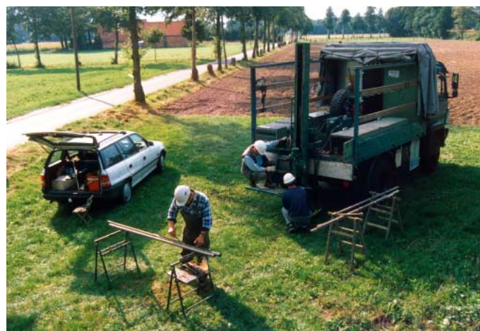
Eine Kleinbohrung gibt Aufschluss über den Schichtenaufbau bis in etwa 10 m Tiefe.
