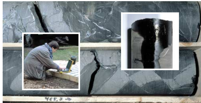
Bei der Untersuchung der Bohrkern vor Ort wurden auch geringe Mengen Erdöl in den Kalksteinen entdeckt.
