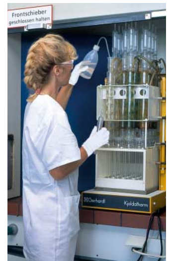
Mithilfe des Königwasseraufschlusses werden die Elementgehalte im Humusproben ermittelt.
