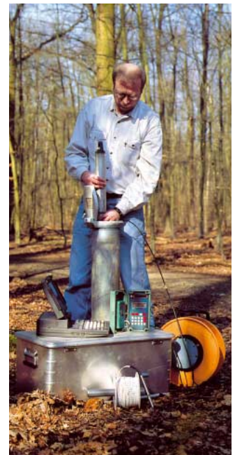
An einer Grundwassermess- stelle wird ein hydraulischer Test durchgeführt.
