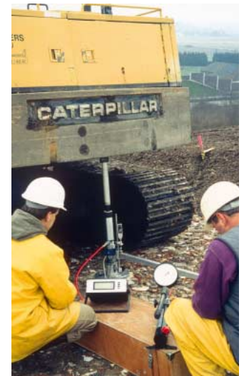
Mit einem Plattendruckversuch wird die Tragfähigkeit des Bodens ermittelt.
