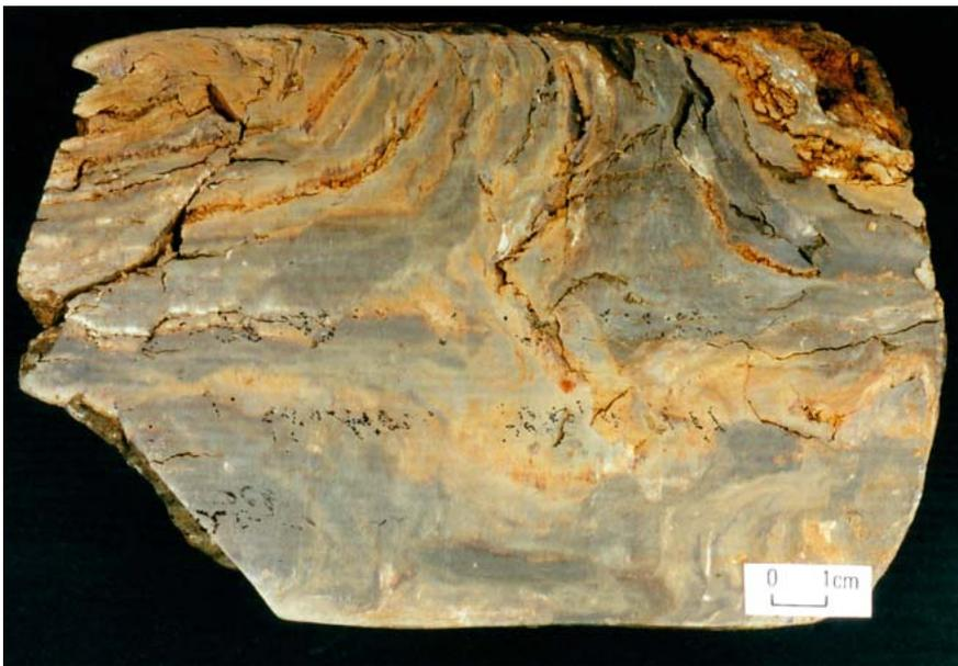
Abb. 6 Paläoboden vom Typ Terra fusca auf Unterem Muschelkalk, Tunnelmeter 804,1 (R 35 98 134, H 57 23 225, 320, 6 m NN)
