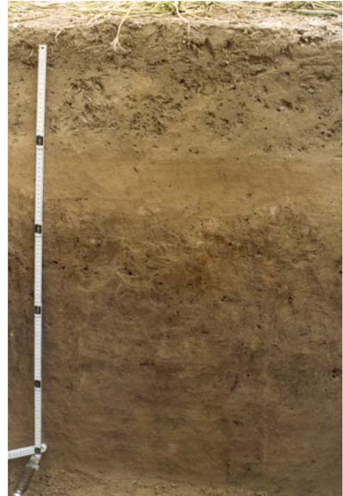
Abb. 4 Schwach erodierte Tschernosem-Parabraunerde aus Löss; bituminöse schwarze Tonfüllung der älteren Grobporen des Toninfiltrationshorizonts ab 40 cm unter Flur
