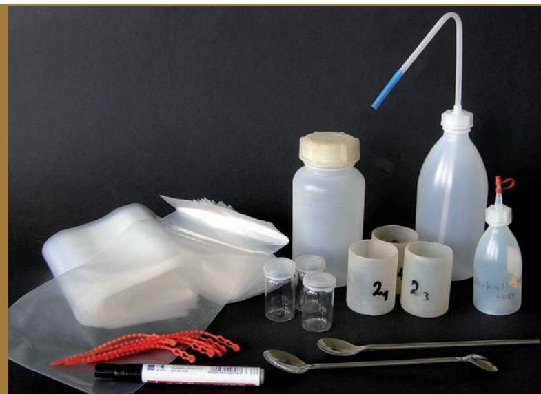
Abb. 3: Utensilien zur Entnahme von Boden- und Wasserproben: Probentüten und Tütenverschlüsse, Flasche für Wasserproben, Permanentstreiber zur Beschriftung der Proben, Rollgläschen für die pH-Wert-Bestimmung, Spritzflasche und Probenbecher
