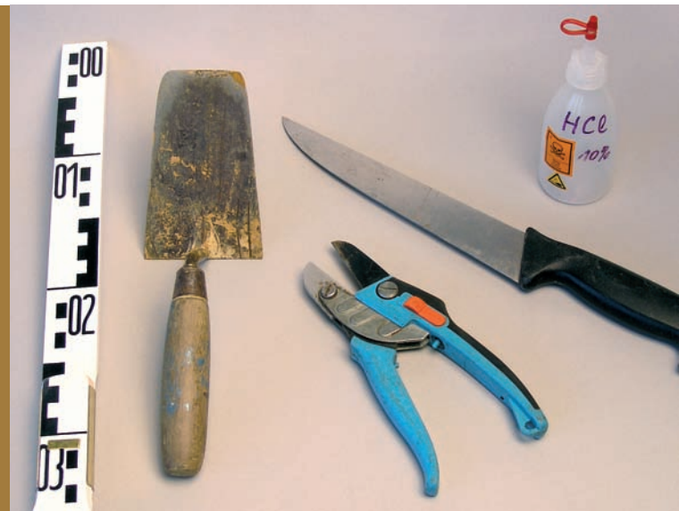
Abb. 2: Nützliche Werkzeuge zum Arbeiten in der Bodenaufgrabung: Fotomaßstab (Messung der Bodentiefe), 10 %ige Salzsäure zur Feststellung des Kalkgehaltes, Kelle, Messer und Wurzelschere zur Präparation der Stirnwand
