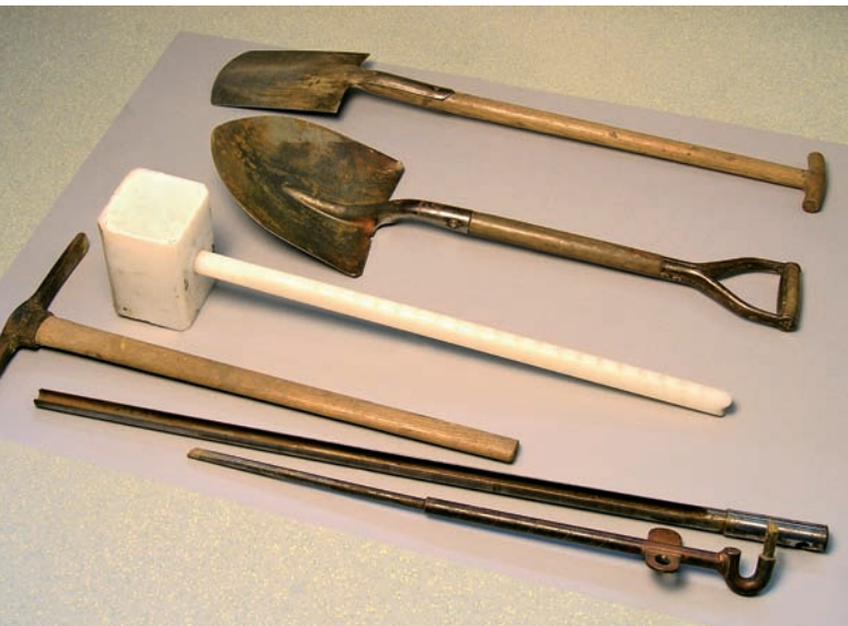
Abb. 1: Unentbehrliche Werkzeuge zur Bodenerkundung im Gelände: Schaufel, Spitzhacke und Spaten für Bodenaufgrabungen, Pürckhauer (Bohrstock) mit Ziehhaken und Hammer für Handbohrungen
