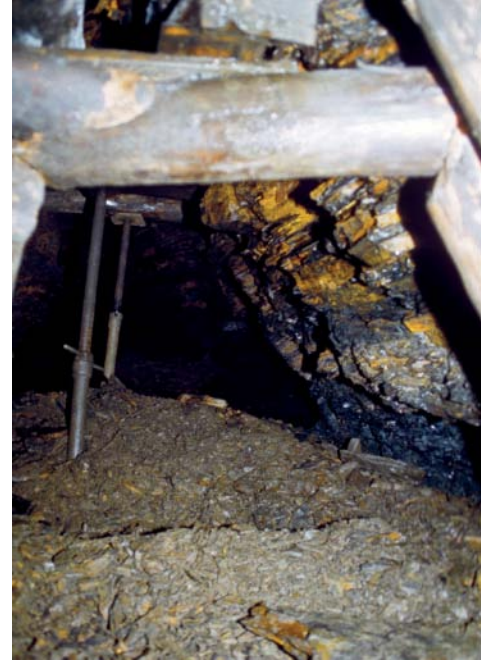
Abb. 117 „10-m-Berg“ mit Schraubstempeln; am rechten Stoß steht das Flöz an, 1994
