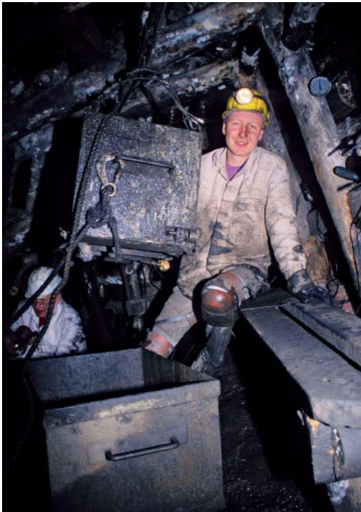
Abb. 176 Umladen des Inhalts eines Hängebahnbehälters mithilfe einer Bodenklappe in einen Förderwagen an der „Bank“ (im Bild THORSTEN KLÜVER)
