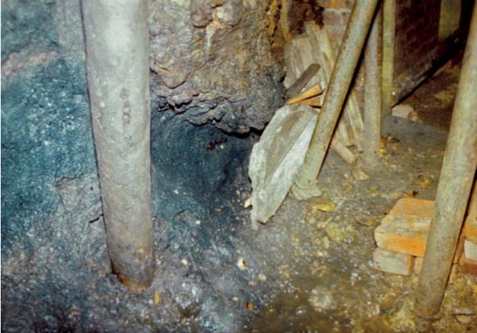
Abb. 145 Flöz Sengsbank mit tektonischem Verwurf
