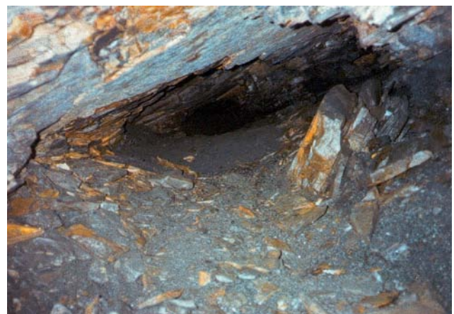
Abb. 76 Abbaustrecke nach Nordosten „r“ vor der Aufwältigung
