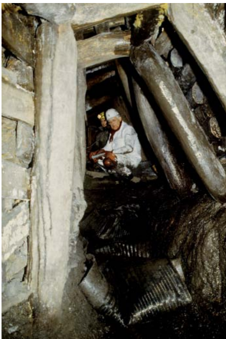
Abb. 123 Der „Rutschenberg“ mit installierter PVC-Rinne
