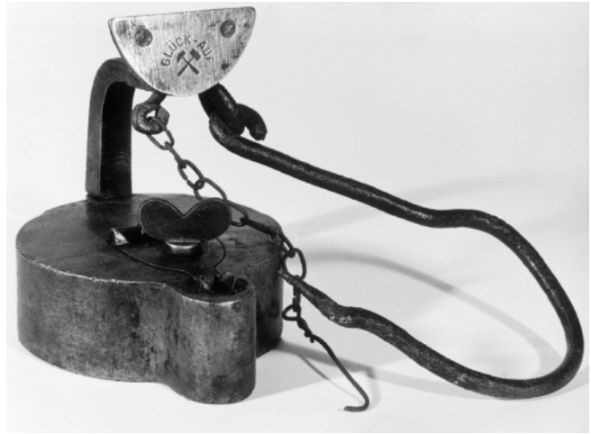
Abb. 189 Rüböl-Grubenlampe, sog. „Westfälischer Frosch“
