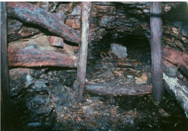
Abb. 84 Schlecht erhaltener ansteigender Förderberg „v“ zwischen Abzweig und Bremsberg
