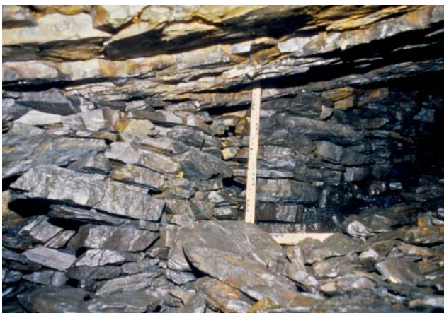
Abb. 94 Bergemauer im Bremsberg
