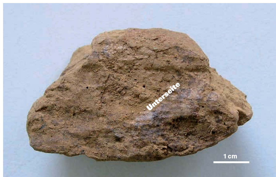
Abb. 37 Scherflächengefüge im Grenzbereich Fließerde/Verschwemmungsablagerungen mit anastomosierender Striemung
