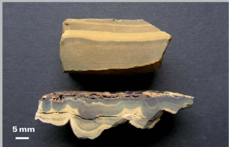
Fig. 3: mit Oxalsäure angeätzter Goethit (Proben 11/2 und 11/4)
