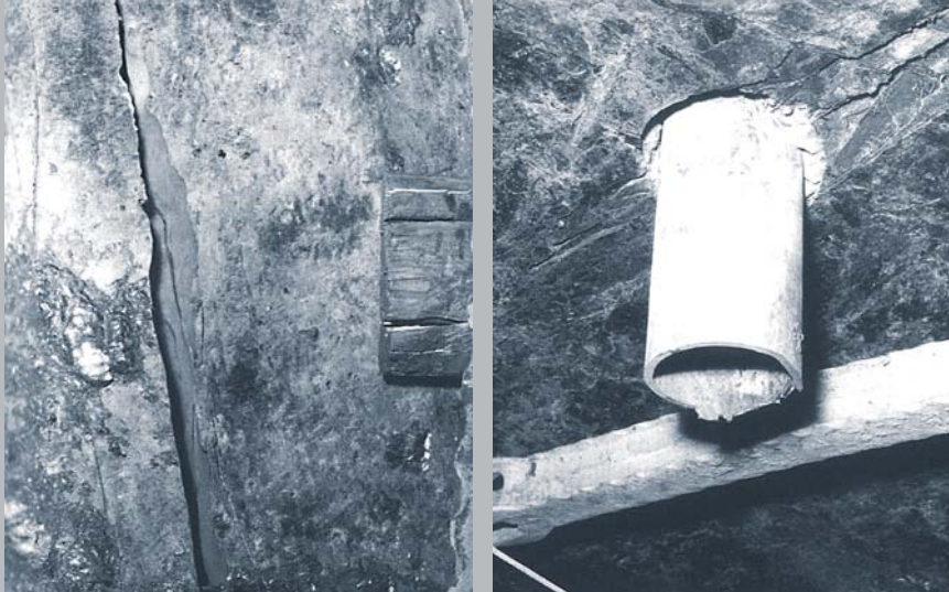
Abb. 23 Durch Fracking erzeugte Risse im Nebengestein eines Kohlenflözes im Saarkarbon (aus KALTWANG 1995)
