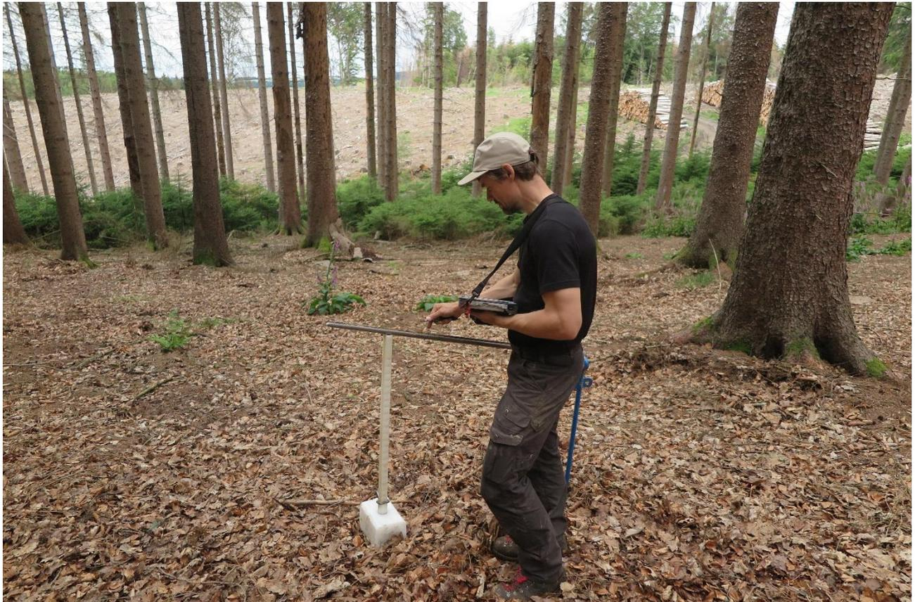
*Abb. 3: Bodenkartierer bei der Dokumentation einer Sondierbohrung mithilfe eines Gelände-Tablets*
