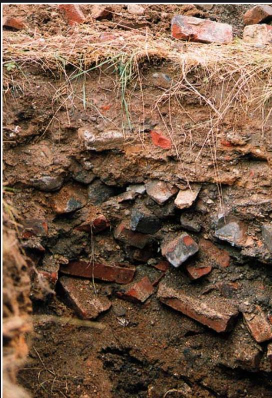
Aufschüttungsboden mit hohem Anteil an Bauschutt
