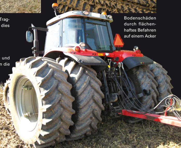
Breitreifen, Doppelbereifung und niedriger Reifendruck können die Bodenverdichtung mindern.
