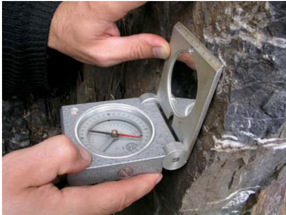
Mit dem Geologenkompass werden die Schichten eingemessen.
