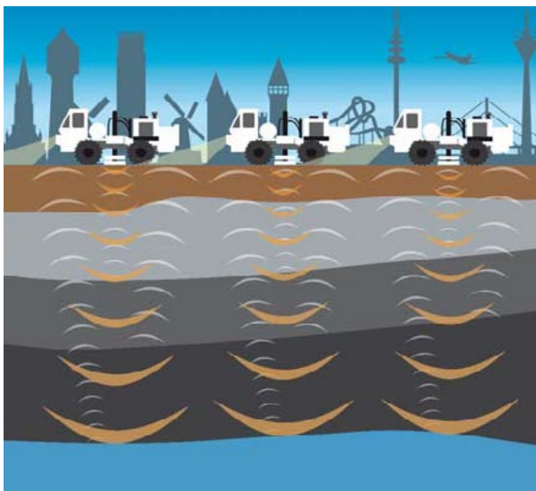
Schema: Vibro-Trucks mit der Reflexion von Schallwellen
