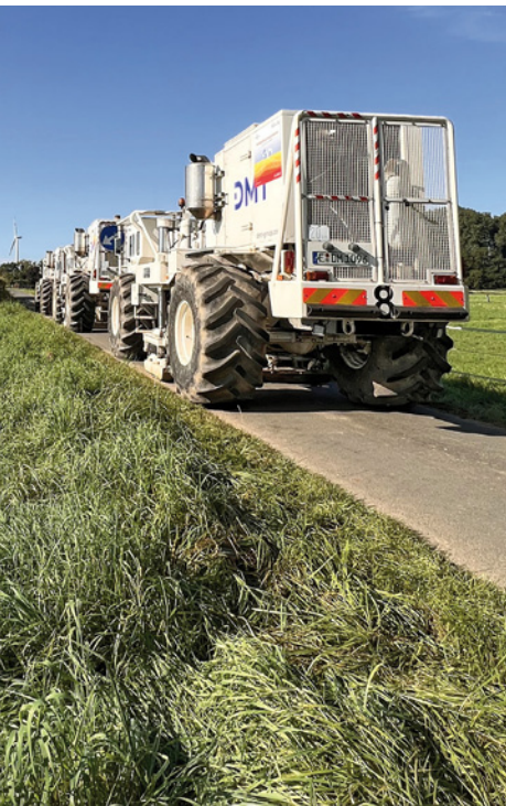
Vibro-Trucks bei der Messung in Wachtendonk
