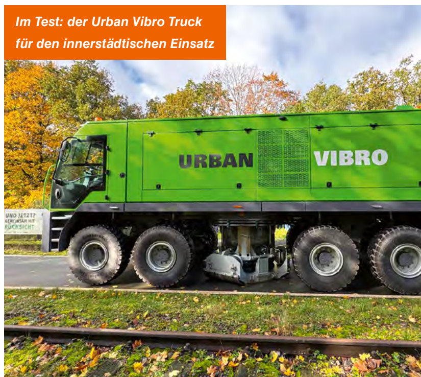
Der eVibe mit komplett elektrisch betriebener Rüttelplatte
