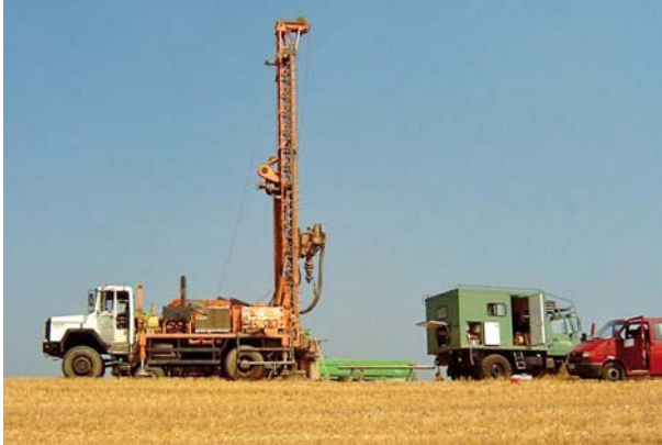
Kartierbegleitende Bohrung mit geophysikalischen Messungen
