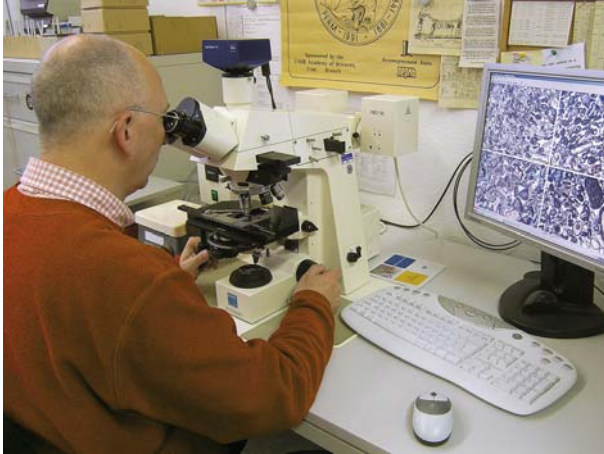
Die Dünnschliffe werden unter dem Mikroskop untersucht.
