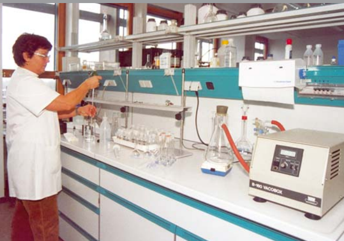
Herstellen von Kalibrierlösungen für die Wasseranalytik
