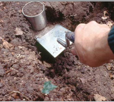
Bodenprobenentnahme mit Stechzylinder
