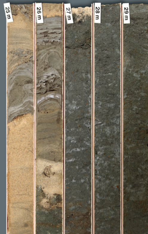
Beispiel für Bohrkern aus quartären Lockergesteinsschichten mit Sand, Schluff und Ton über Sandmergel aus der Kreide-Zeit (Dorsten-Holsterhausen)
