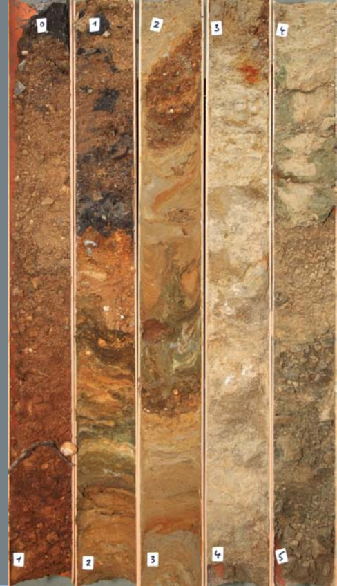
Beispiel für Bohrkern aus Lockergesteinsschichten mit künstlichen Aufschüttungen, Sand, Schluff und Kies
