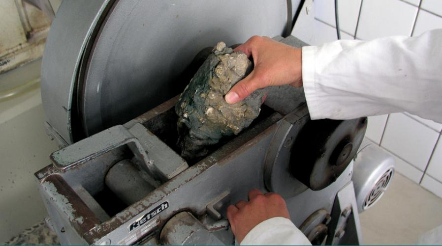
Nach der Registrierung werden die Proben mit einem Backenbrecher zerkleinert.
