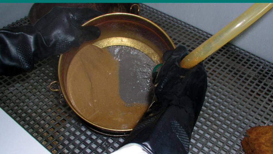
Die Proben werden zur Gewinnung der darin enthaltenen Mikrofossilien mit Wasserstoffperoxid aufgelockert und durch ein 0,1 mm feines Sieb geschlämmt.
