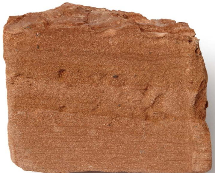
Abb. 21 Streifiger, rotbrauner Feinsandstein mit schichtigen Einlagerungen von Mittel- und Grobsandlagen (Untere Niederrhein-Formation; Bohrung Prosper V; TK 25: Blatt 4407 Bottrop; Tiefe: 397,2 m; BNUM: 83119; Bohrkern: Sammlung Geologischer Dienst NRW)
