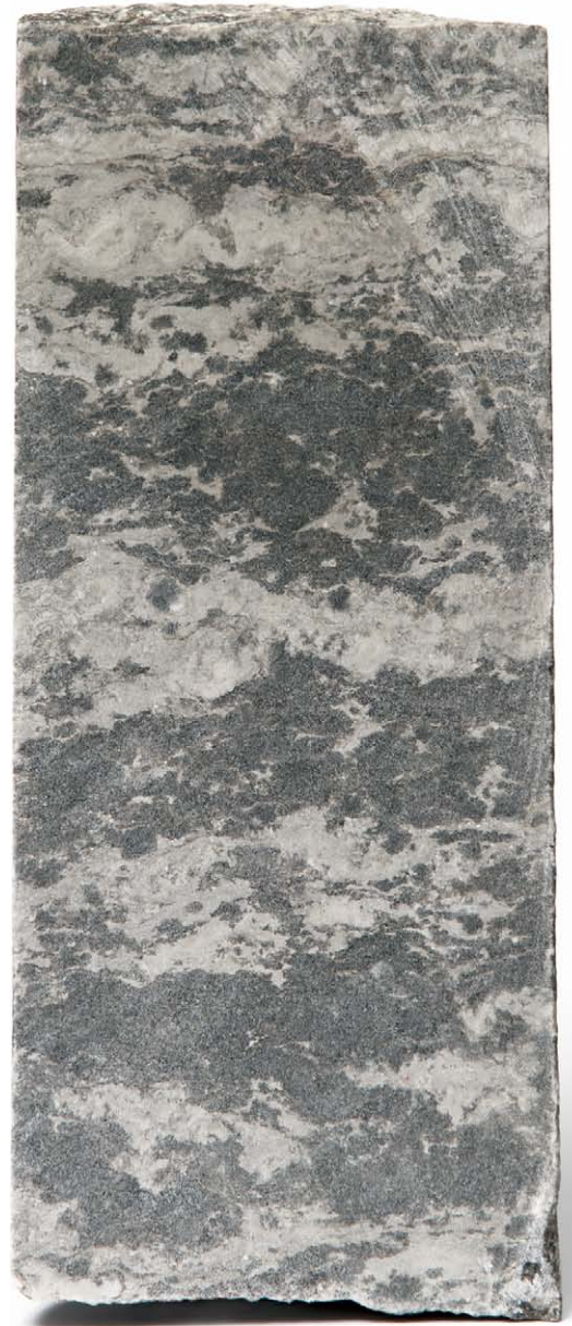
Abb. 18 Mittelgrauer, hier grobkristalliner Anhydrit, wechsellagernd mit unregelmäßigen, grauweißen, dichten Karbonatbändern (Magnesit) mit schlierenartiger Gelstruktur; Unterer Werra-Anhydrit (17 cm langer Bohrkern aus der Bohrung Schwarzer Bach 5; TK 25: Blatt 4407 Bottrop; Teufe: 481,7 m; BNUM: 82995; Bohrkern: Sammlung Geologischer Dienst NRW)
