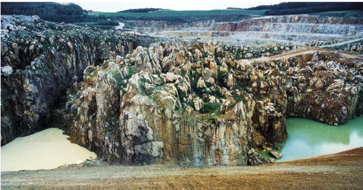
Abb. 15 Kegelkarst im Massenkalk. Vor dem Kalksteinabbau müssen die überlagernden Sande und Lehme aufwendig abgeräumt werden. Wülfrath, Steinbruch Rohdenhaus-Nord (76)
