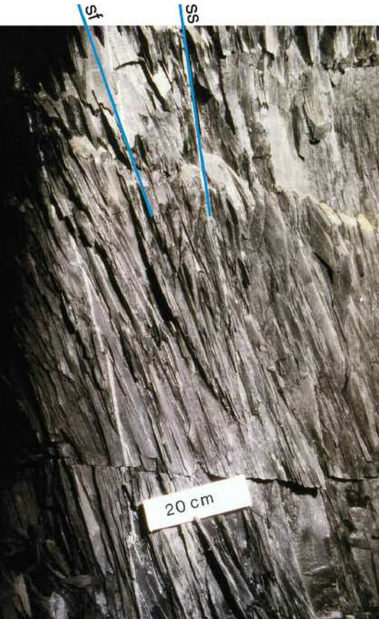
Abb. 9 Fredeburger Dachschiefer mit spitzwinkliger Lage der Schieferung (sf) zur Schichtung (ss). Werk Fredeburg (64) (aus HEIß 1993)
