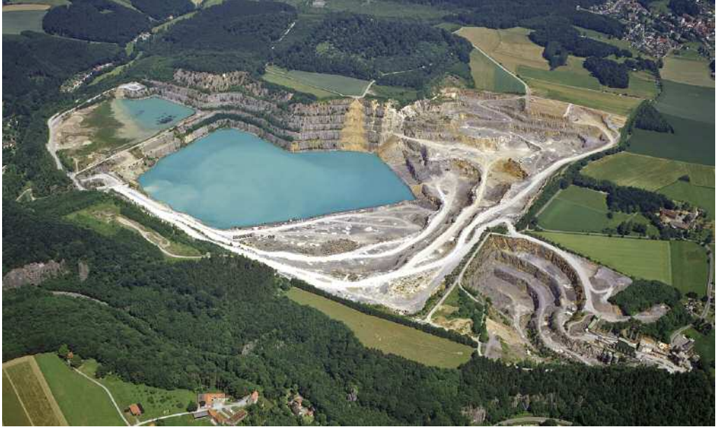
Abb. 52 Steinbruch Asbeck. In der Mitte der alte Abbau mit Klärteichen, rechts dahinter der aktuelle Abbau. Werk Hönnetal (82). Rechts unten Werk Horst (83) (Luftbild: Rheinkalk GmbH, Wülfrath)
