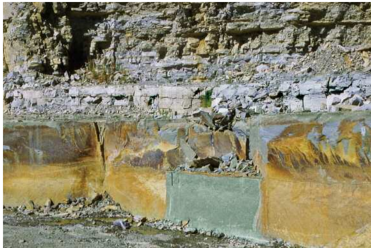
Abb. 37 Anröchter Grünsandstein: grüne und blaue Bank mit eisenreichen Kluftbelägen, überlagert von dünnbankigen Kalksteinen (ab weißlicher Lage). Anröchte
