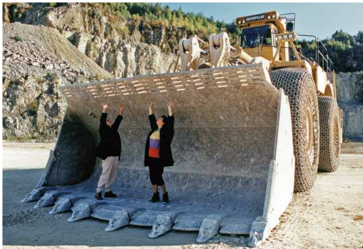
Abb. 20 Überdimensionaler Radlader mit einem Fassungsvermögen der Schaufel von 12 m 3 . Wülfrath, Steinbruch Rohdenhaus-Nord (76)
