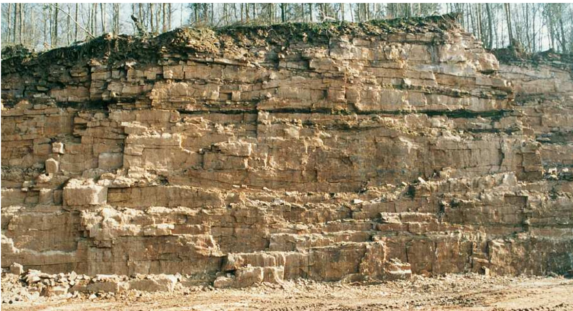
Abb. 36 Wesersandstein: Ablagerungen zahlreicher übereinanderfolgender Flussrinnen. Bad Karlshafen, Werk Westfalentor (49); Blick nach Osten
