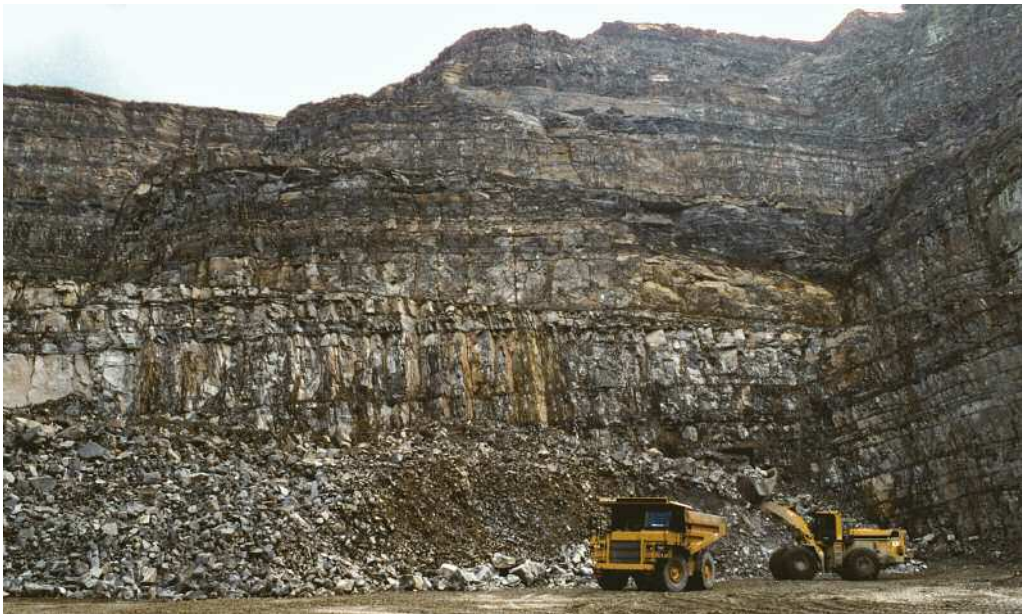
Abb. 32 Dickbankige Sandsteine der Honsel-Schichten mit dünnen Tonschieferzwischenlagen. Werk Werdohl-Kleinhammer (36)
