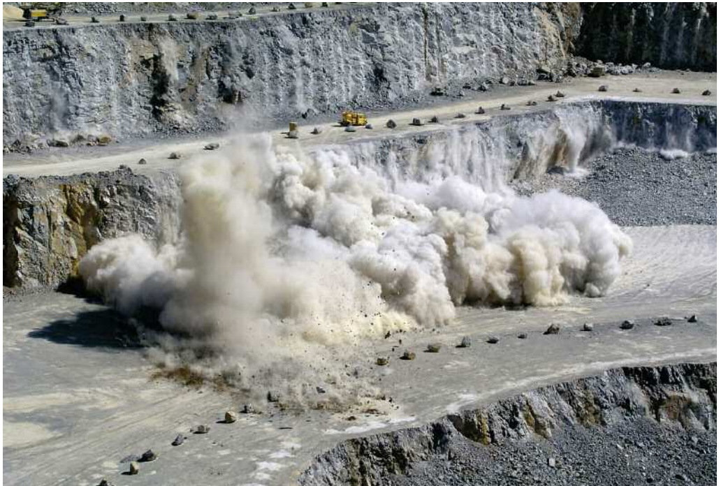
Abb. 19 Sprengung im Massenkalk (im Vordergrund Haufwerk einer früheren Sprengung). Wülfrath, Steinbruch Rohdenhaus-Nord (76)
