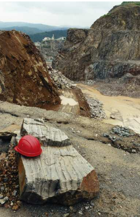
Abb. 24 Abbau von Effusiv-Diabas, im Vordergrund ein Tuffitblock, Brilon, Werk Am Bilstein (5)
