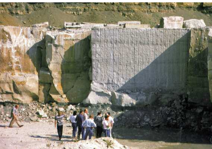
Abb. 13 Rohblockgewinnung mittels Loch-an-Loch-Bohrungen für Naturwerksteine (am Beispiel der Gewinnung von Keuper-Sandstein bei Bamberg/Franken)
