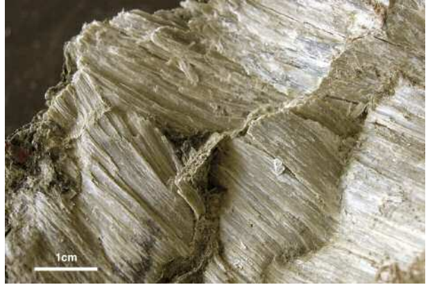
Abb. 22 Aktinolith-Asbest, ein faseriges Mineral als Kluftausfüllung im Intrusiv-Diabas. Winterberg, Werk Silbach (3)
